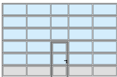
Gangdør placeret i midten
