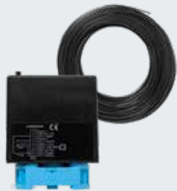
Induktionssløjfe Detektor med lukker og veksler, kan indstilles til impulskontakt eller vedvarende kontakt, retningsregistrerende, 50 m sløjfekabel
